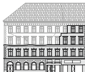
Ansicht Mariahilfer Straße: 1. Bestandsansicht – 2. Beschädigung durch Gasexplosion – 3. Baulinie Neuaufbau – 4. Ansicht nach Sanierung
