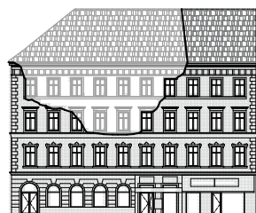
Ansicht Mariahilfer Straße: 1. Bestandsansicht – 2. Beschädigung durch Gasexplosion – 3. Baulinie Neuaufbau – 4. Ansicht nach Sanierung
